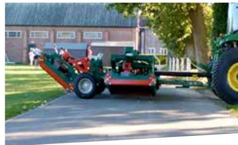
**PRO-LIFT - ERMÖGLICHT EIN SCHNELLES TEIL-ANHEBEN DER DECKS ZUM ÜBERQUEREN VON WEGEN**
