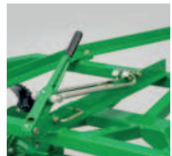
Handhebel zum Anheben der Schneideinheit
