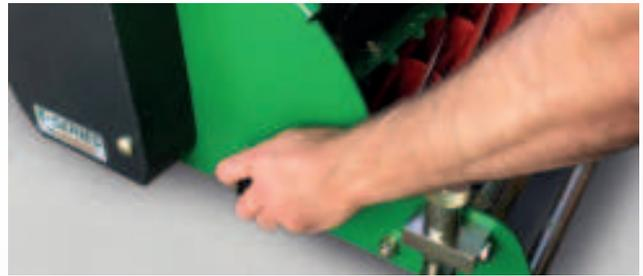
*Klemmschraube lösen und Kassette nach links schieben*
