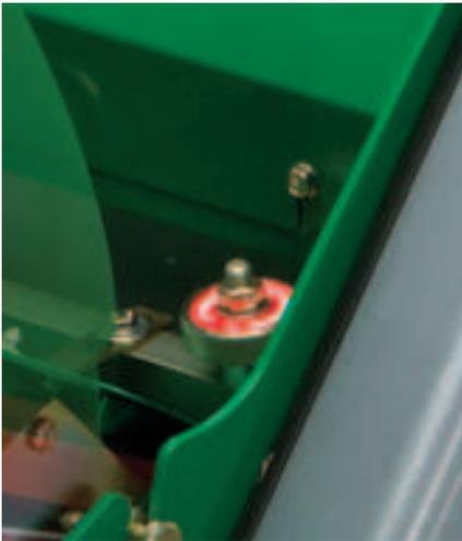
Einfache Einstellung des Untermessers an den Zylinder
