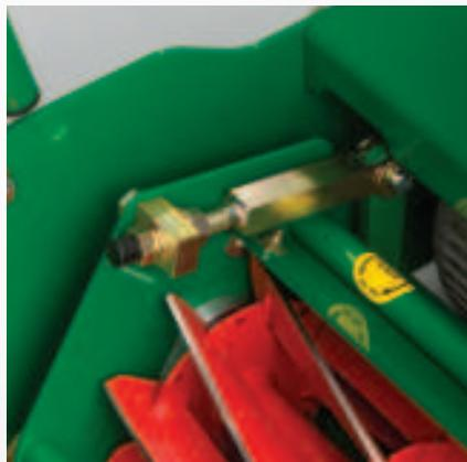
Einfache und sichere Einstellung des Zylinders auf das Untermesser mit einem einzigen Schraubenschlüssel
