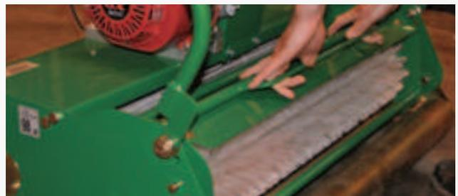
Neue Kassette in das Gehäuse einlegen
