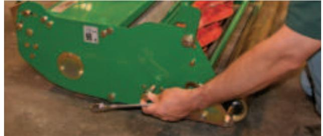
Klemmschraube lösen und Kassette nach links schieben
