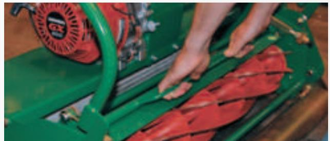
*Kassette aus dem Gehäuse herausheben*
