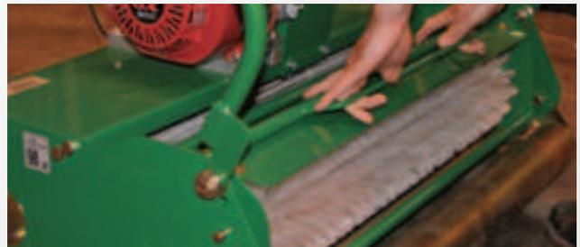
*Neue Kassette in das Gehäuse einsetzen*
