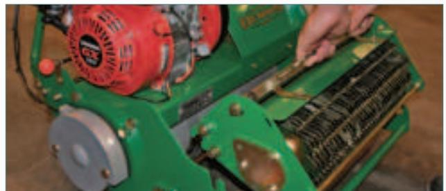
Kassette aus dem Gehäuse herausheben
