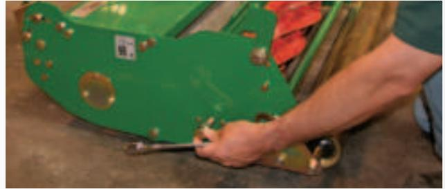
*Klemmschraube lösen und Kassette nach links schieben*
