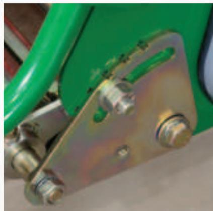
Präzise Schnitthöhensteuerung, die mit einem einzigen Schraubenschlüssel leicht eingestellt werden kann
