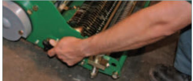
Klemmschraube lösen und Kassette nach links schieben
