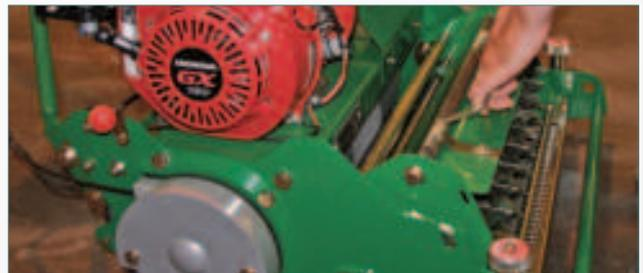
Neue Kassette in das Gehäuse einsetzen
