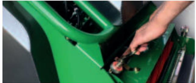
*Kassette aus dem Gehäuse herausheben*
