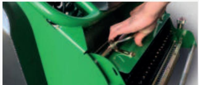
*Neue Kassette in das Gehäuse einsetzen*
