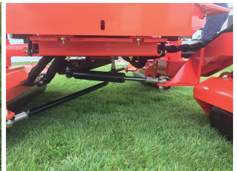
Hydraulische Lenkung (serienmässig am XXL70)
