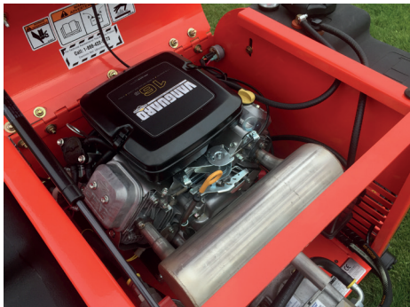
2-Zylinder Vanguard Benzinmotor mit 12kW/16PS, leicht zugänglich
